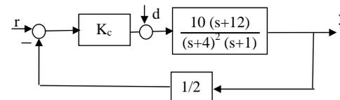
con Kc positivo, tramite la tecnica del luogo delle radici:
